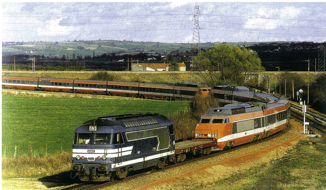
После окончания тестовых поездок по новой трассе испытательный состав тянет тепловоз по неэлектрифицированному участку в Моншанене.
