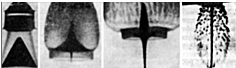
Рис. 2.17. Рентгенограмма срабатывания кумулятивного заряда, слева направо: взрыв заряда, начало формирования из облицовки и дальнейшее развитие кумулятивной струи, прорыв остатка кумулятивной струи сквозь броню
