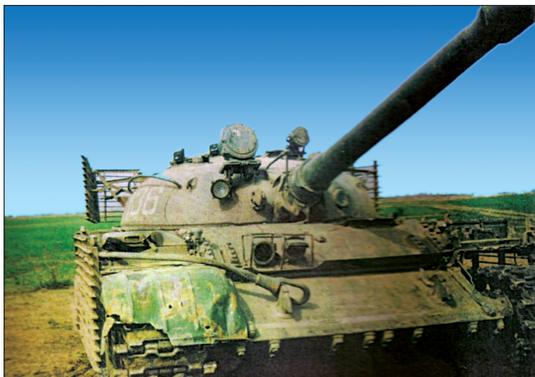
Рис. 2.16. «Противокумулятивные» решетки на бортах и башне танка Т-62. Чечня, 2000 г.
