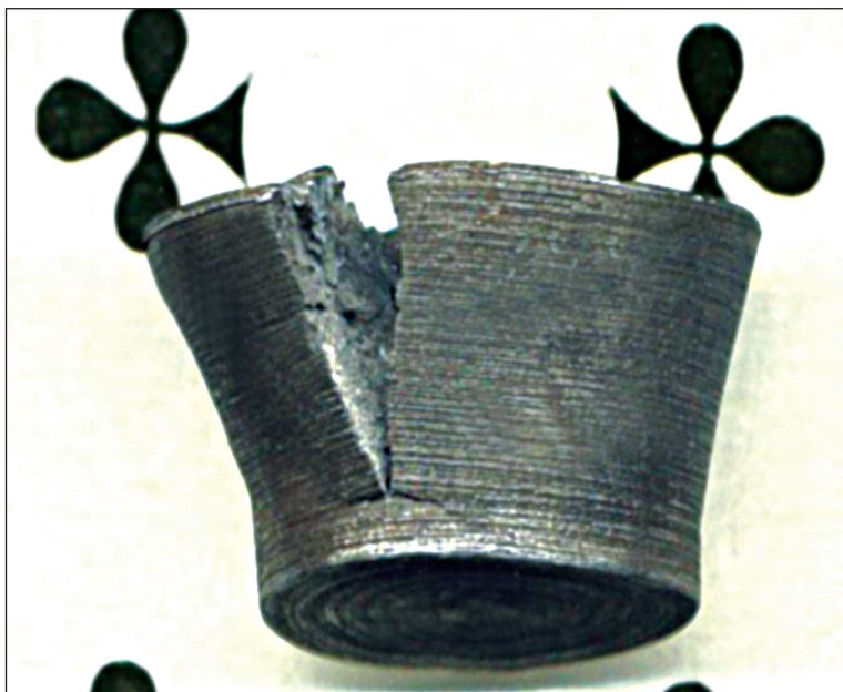
Рис. 2.13. Стальной цилиндр, сжатый давлением взрыва, а затем «расташенный» волной разрежения («разгрузкой»)
