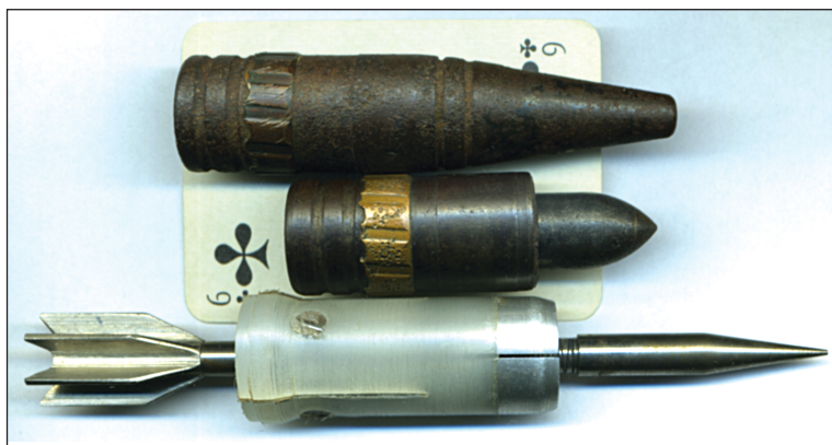
Рис. 2.10. Эволюция бронебойных снарядов к авиационной пушке калибром 23 мм.
