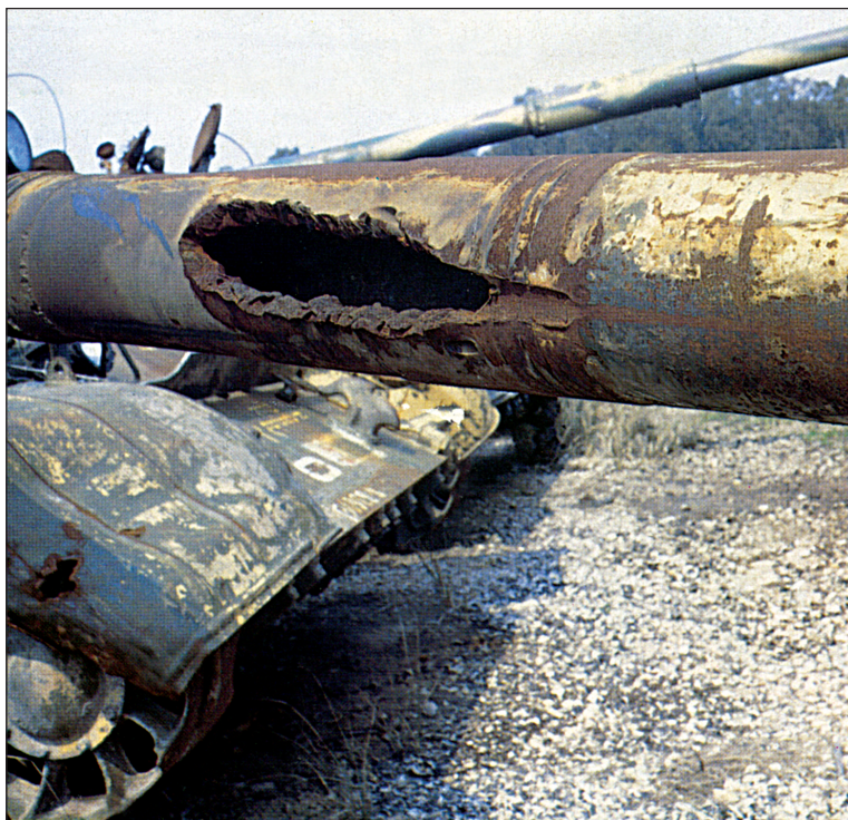
Рис. 2.12. Малый угол встречи и высококачественная сталь не помешали «лому» 105 мм израильского подкалиберного снаряда APFS-DS-T «закусить» и пробить ствол пушки сирийского танка Т-62 (советского производства)
