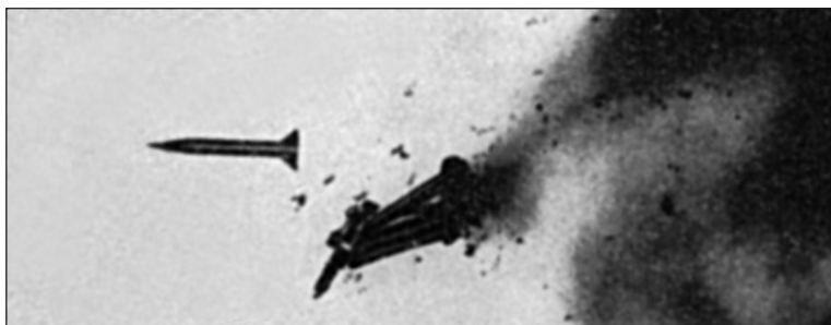
Рис. 2.11. Выстрел из танковой пушки подкалиберным снарядом. В середине снимка видны отделившиеся части поддона, справа – газы выстрела
