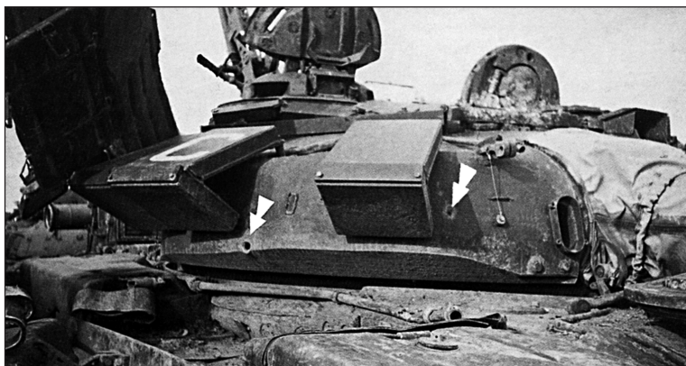
Рис. 2.15. Танк Т-72БМ, Грозный, январь 1995 г. Места поражения кумулятивными боеприпасами показаны стрелками; слева от каждой из стрелок видны «коробки» динамической защиты
