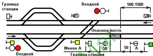
Рис. 5. Схема ограждения мест производства работ на перегоне вблизи станции, требующих следования поездов с уменьшенной скоростью
